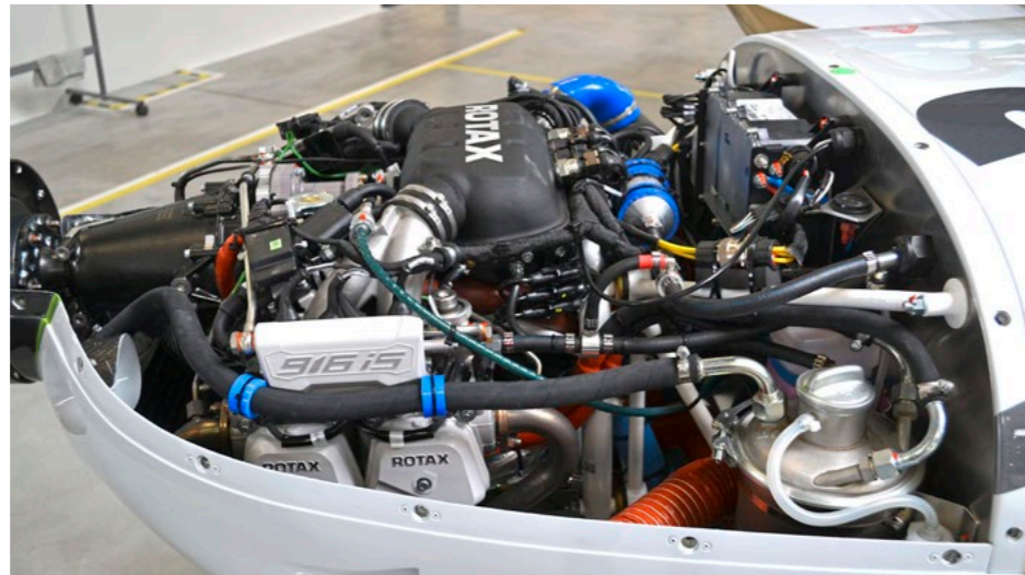
Der 916 iS mit 160 PS Startleistung ist das aktuelle Topmodell von Rotax – und passt somit perfekt in die VL3, deren Eigner sich zumeist das Beste vom Besten wünschen.
